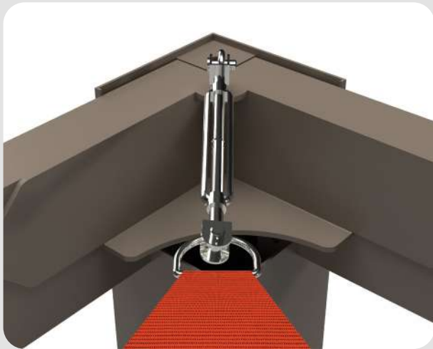
Chaque point d'accroche est fixé à l'aide d'un ridoir réglable permettant une tension parfaite de la voile d'ombrage.
